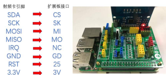
射频卡连接示意图
