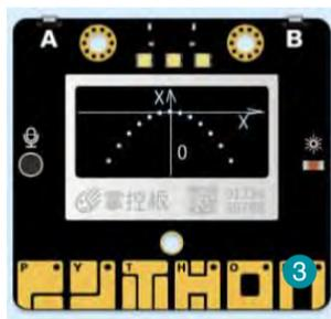
平线及原点。三是根据列表中对应的数据,通过描点的方式将数据在屏幕中显示出来。四是按照坐标从小到大的顺序把所有描出的点用平滑的曲线连接起来(图3)。
