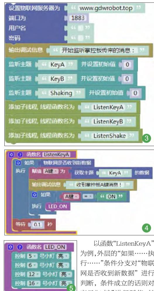
以函数“ListenKeyA”为例,外层的“如果……执行……”条件分支对“物联网是否收到新数据”进行判断,条件成立的话则对变量“A键”进行赋值,其值为“获取主题‘KeyA’的数据”;接着输出调试信息“收到掌控板 A 键消息!”,表示已经收到了掌控板按键 A 的动作消息;然后再用内层“如果……执行……”条件分支对“A 键”的值是否为“ON”进行判断,条件成立,说明掌控板的 A 键已经被按下,于是调用“LED\_ON”函数(如图4),执行由 5、6、12 和 16 四支 LED 所组成的灯阵全部发光的动作(如图5);最后的 0.1 秒等待语句,作用仍然是防止程序过多占用系统资源。
