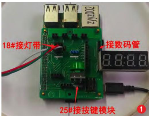
置3号数码管显示“0”(不显示点),实现题目中(1)对数码管“只有最后一位显示0”的显示要求(如图2)。
